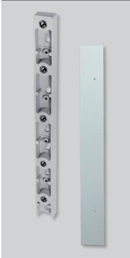
■ Держатель шинных систем D100/185 предназначен для крепления шин в кабельных распределительных шкафах и в проводке низкого напряжения. Держатель шинных систем изготовлен из полиэфира, армированного стекляннным волокном. Сама конструкция держателя и правильный выбор материала определяет и высокую устойчивость по отношению к динамическому воздействию тока короткого замыкания.
